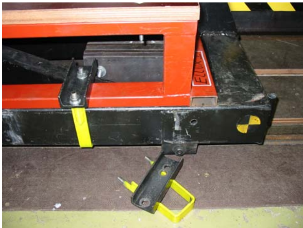
Abb.4: Klemmschellen zur Befestigung des Prüfgestells
