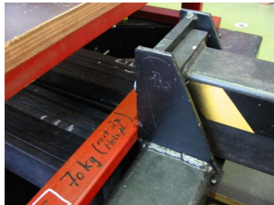
Abb.5 Querrohr des Prüfgestells als Anschlag am Dorn des Versuchsträgers
